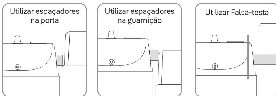
⚠ Confirme que o trinco estará centralizado (verticalmente e horizontalmente) no batente. O trinco não deve encostar ou raspar no batente para a correta operação da YBL 410S.
