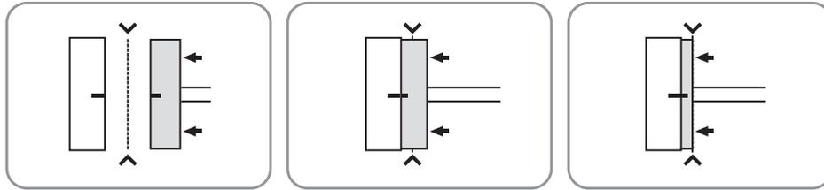
**⚠** Pressione o conector do cabo principal até a marcação tracejada da placa para garantir um encaixe correto.
