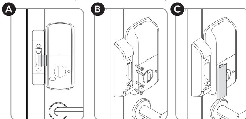
⚠ Caso não seja possível alinhar o batente e a parte interna com ou sem os espaçadores (a), faça um rebaixo na guarnição para encaixar o batente utilizando uma broca-chata e um formão (b).
