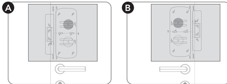
⚠ Antes de realizar os furos, simule o posicionamento da parte interna e do batente e certifique-se de que ambas peças estão alinhadas como na figura abaixo.
